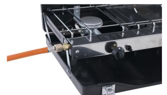
c. Wenn Ihr Schlauch mit einem Linksgewinde von ¼ Zoll ausgestattet ist, schieben Sie den Schlauch direkt auf den Gaseinfüllstutzen (4).
