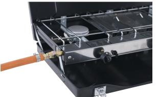
Hvis din slange har en innvendig diameter på 10/11 mm, skyv slangen hele veien over den ribbede delen av den avtakbare slangenippele. Gjenge slangen og nippelen inn på gasstilkoblingen (4).
