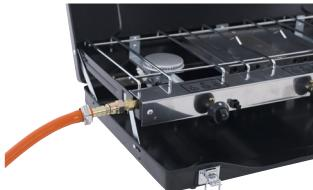
Hvis din slange har en innvendig diameter på 8 mm, skyv slangen over den første ribbede halvdelen av den avtakbare slangenippele. Gjenge slangen og nippelen inn på gasstilkoblingen (4).
