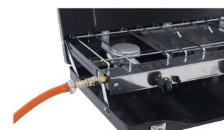
a. Hvis slangen har en intern diameter på 8 mm, skubbes den over den første ribhalvdel af den aftagelige slangetylle. Stik slange og tylle ind i gasindgangen (4).
